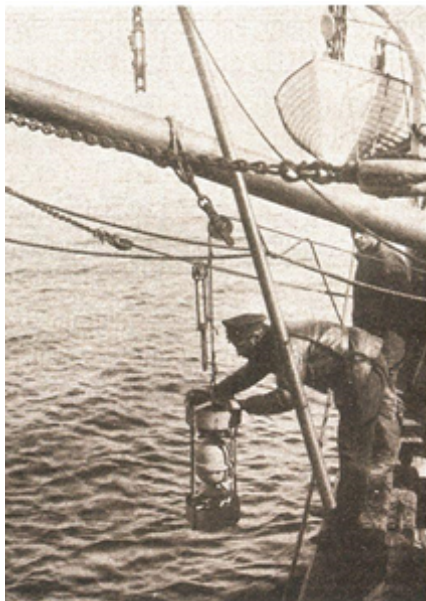
1901 г. Русская полярная экспедиция в Карском и Восточно-Сибирском морях Северного Ледовитого океана. Гидрограф А. В. Колчак набирает воду для гидрохимического анализа.
