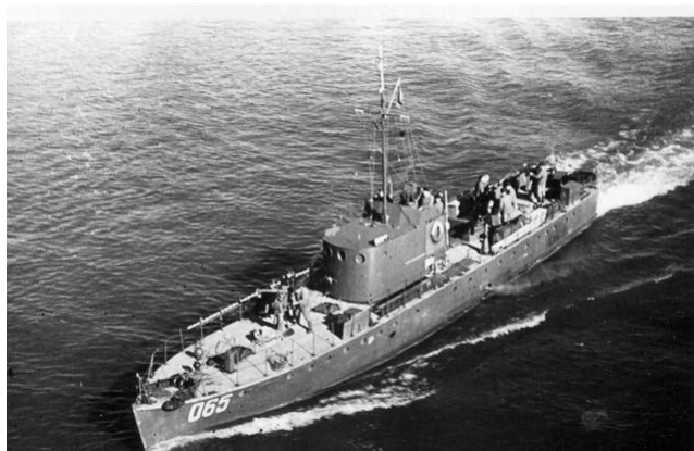
Малый охотник типа МО-IV («мошка», «морской охотник») предназначен для поиска, слежения и уничтожения подводных лодок в ближней морской и прибрежной зоне, несения дозорной службы или охранения транспортных судов и кораблей. Наибольшее развитие МО-IV получили в годы Второй мировой войны. Вооружение их состояло из глубинных бомб и малокалиберных орудий.
